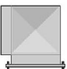
90 · bend (left-bottom) duct
