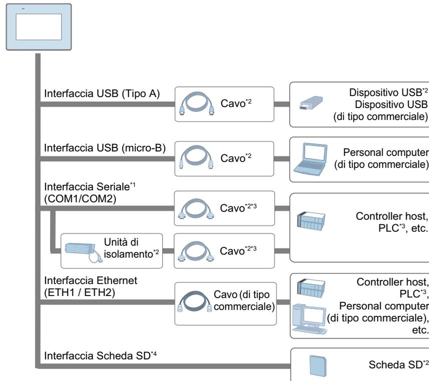
\*1 Per utilizzare questa come porta isolata, occorre l'Unità di isolamento. Per usare l'unità di isolamento RS-232C, impostare il piedino #9 della porta COM su VCC.
