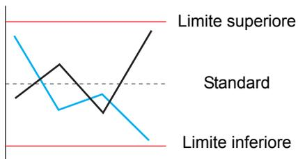
Si possono impostare tre linee ausiliarie: Limite superiore, Limite inferiore e Standard. Si può facilmente determinare se si è verificato un errore.
