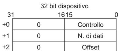
Quando si vuole controllare il Visualizzatore grafici da un dispositivo/PLC, lo schermo differirà in base all'impostazione dell'[Indirizzo word di controllo] a un indirizzo di dispositivo o usare l'Area lettura interna dell'unità GP.
