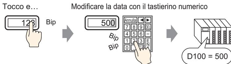
Visualizzare i dati inseriti in un indirizzo word designato nel dispositivo/PLC come valore numerico.
