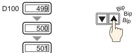
Quando si usa la funzione Addizione/Sottrazione dati di un Tasto word, i dati cui si fa diretto riferimento in un Visualizzatore dati possono essere modificati. Quest'operazione è utile per la messa a punto e per regolazioni su scala minore.
