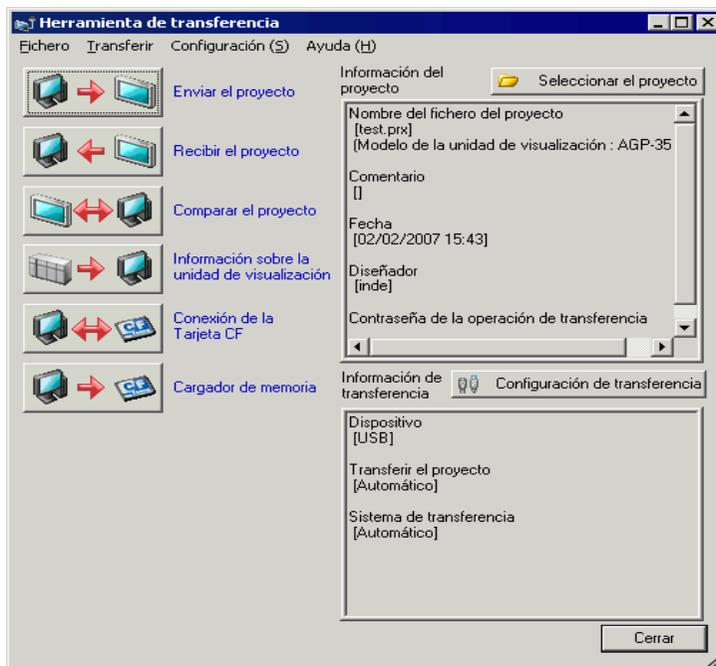
2 Haga clic en [Configuración de transferencia] para mostrar el cuadro de diálogo [Configuración de transferencia]. Asegúrese de que [Configuración del puerto de
