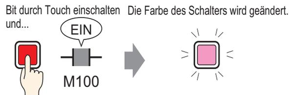
Kombinieren Sie einen Schalter mit der Lampen-Funktion, und Sie können die Farbe des Schalters entsprechend des bestimmten Status (EIN/AUS) ändern.
