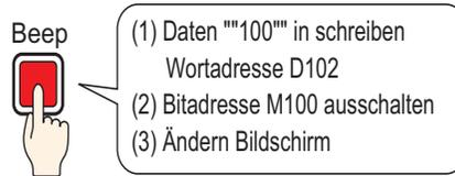
Ein einziger Schalter kann mit bis zu 16 Schalteroperationen eingestellt werden. Wenn die zuerst registrierte Adresse der Schalteroperation aktiviert wird, werden die Schalterausführungen in der registrierten Reihenfolge ausgeführt. Die Reihenfolge der Schalteroperationen kann bestimmt werden. Die Aktion Bildschirmwechsel wird ausführen, wenn sie als letzte Operation in der Reihenfolge registriert wurde. Diese Funktion ist für Bildschirme mit begrenztem Platz nützlich.
