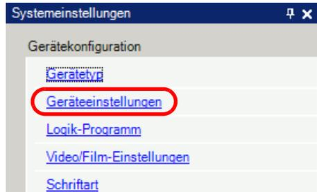
3 Legen Sie auf der Registerkarte [Gerätekonfiguration] die [Bildschirmnummer beim Start] auf 1 fest, um diesen Bildschirm beim Einschalten des GP anzuzeigen. Dieser Bildschirm wird bei Einschalten als erstes angezeigt.
