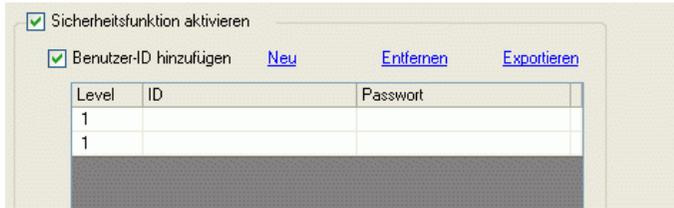
3 Legen Sie die Sicherheitsstufe, die Benutzer-ID und das Passwort für die Überwachung der Zustände und das Wartungspersonal fest. (Beispiel: Statusüberwachung: [Level] = "1", [Passwort] = "1111", [ID] = "Monitor"; Wartung: [Level] = "15", [Passwort] = "5555", [ID] = "Admin")
