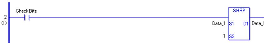
Es besteht ein Unterschied zwischen der SHRP- und SHR-Anweisung beim Ausführen der Anweisung. Bei SHRP-Anweisungen wird bei Verwenden einer normalerweise offenen Anweisung nur der Übergang nach oben festgestellt und die SHRP-Anweisung wird ausgeführt. Deshalb wird die SHRP-Anweisung nur für eine Abtastung ausgeführt, selbst wenn die normalerweise offene Anweisung eingeschaltet bleibt.
