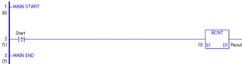
(1) Wenn die positive Übergangsanweisung eingeschaltet wird, wird die BCNT-Anweisung ausgeführt. Beim Ausführen der BCNT-Anweisung werden die EIN-Bits im Wert 10 (Binär 1010) gezählt und das Ergebnis von 2 in den Ergebnisdaten gespeichert. Die Ergebnisdaten werden in D1 konfiguriert.
