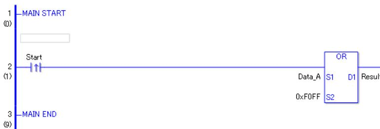
(1) Wenn die positive Übergangsanweisung eingeschaltet wird, wird die OR-Anweisung ausgeführt. Wenn die OR-Anweisung ausgeführt wird, wird der Ergebniswert in D1 gespeichert, nachdem die Daten\_A mit F0FF durch OR logisch verknüpft wurden. Wenn eine normalerweise offene Anweisung verwendet wird, wird eine OR-Anweisung immer ausgeführt, so lange die Variable eingeschaltet ist.
