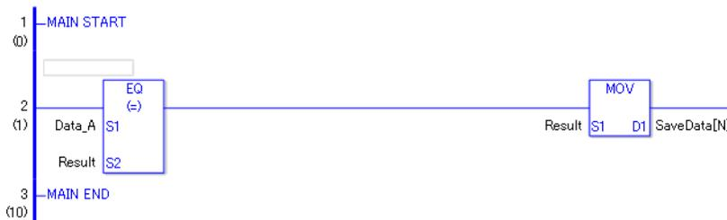
(1) Daten\_A und das Operationsergebnis werden verglichen, um festzustellen, ob sie gleich sind. Wenn das Ergebnis der EQ-Anweisung S1= S2 ist, lässt die EQ-Anweisung Spannung durch und die Anweisung rechts der EQ-Anweisung wird ausgeführt. In der obigen Abbildung handelt es sich dabei um eine MOV-Anweisung.
