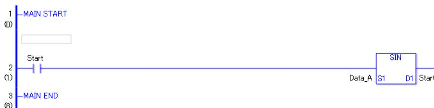
(1) Die SIN-Anweisung wird ausgeführt, wenn sich die positive Übergangsanweisung einschaltet. Die SIN-Anweisung berechnet den Sinus der Daten\_A und speichert das Ergebnis in D1.
