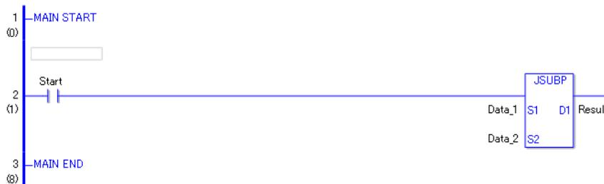
(1) Wenn die normalerweise offene Anweisung eingeschaltet wird, wird die JSUBP-Anweisung ausgeführt. Wenn eine JSUBP-Anweisung ausgeführt wird, werden die Daten 2 (Zeitvariable) in Operand S2 von den Daten 1 (Zeitvariable) in Operand S1 abgezogen und das Ergebnis dieser Subtraktion in Operand D1 gespeichert. Selbst wenn eine normalerweise offene Anweisung verwendet wird, wird ein Übergang nach oben nur festgestellt, wenn die JSUBP-Anweisung ausgeführt wird.
