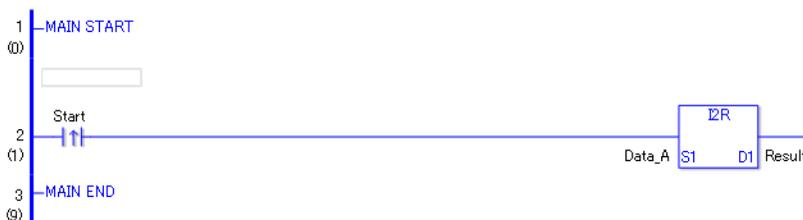
(1) Wenn die positive Übergangsanweisung eingeschaltet wird, wird die I2R-Anweisung ausgeführt. Wenn die I2R-Anweisung ausgeführt wird, wird das Ergebnis der I2R-Konvertierung der Daten\_A in D1 gespeichert.
