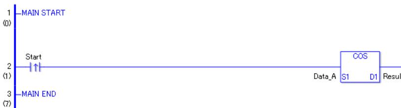
(1) Wenn die positive Übergangsanweisung eingeschaltet wird, wird die COS-Anweisung ausgeführt. Die COS-Anweisung berechnet den Kosinus der Daten\_A und speichert das Ergebnis in D1.
