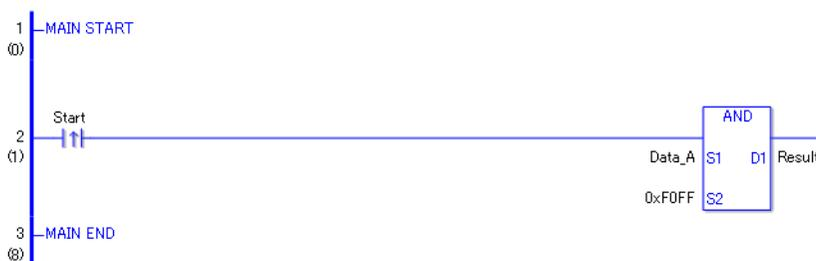
(1) Die AND-Anweisung wird ausgeführt, wenn sich die positive Übergangsanweisung einschaltet. Wenn die AND-Anweisung ausgeführt wird, wird der Ergebniswert in D1 gespeichert, nachdem die Daten\_A mit F0FF durch AND logisch verknüpft wurden. Wenn eine normalerweise offene Anweisung verwendet wird, wird die AND-Anweisung fortlaufend bei jeder Abtastung ausgeführt (führt die logische AND-Operation durch).
