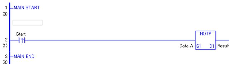
(1) Wenn eine normalerweise offene Anweisung eingeschaltet wird, wird die NOTP-Anweisung ausgeführt. Wenn die NOTP-Anweisung ausgeführt wird, wird der Ergebniswert in D1 gespeichert, nachdem die Daten\_A logisch invertiert wurden. Die NOTP-Anweisung wird nur ausgeführt, wenn ein Übergang nach oben festgestellt wird, selbst wenn eine normalerweise offene Anweisung verwendet wird. Selbst wenn die Variable der NO-Anweisung immer EIN ist, wird die NOTP-Anweisung nur für eine Abtastung ausgeführt.
