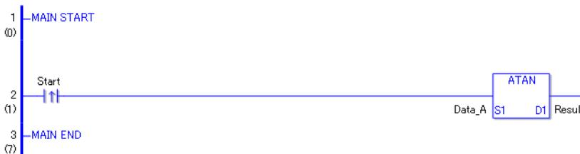
(1) Wenn die positive Übergangsanweisung eingeschaltet wird, wird die ATAN-Anweisung ausgeführt. Die ATAN-Anweisung berechnet den Arkustangens der Daten\_A und speichert das Ergebnis in D1.
