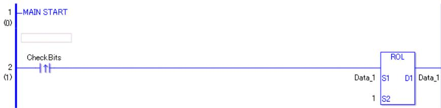
(1) Wenn eine positive Übergangsanweisung eingeschaltet wird, wird die ROL-Anweisung ausgeführt. Wenn eine ROL-Anweisung ausgeführt wird, wird das Ergebnis (1 Bit drehen) in D1 gespeichert.
