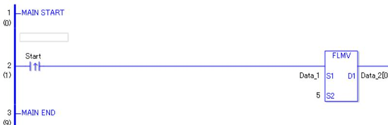
(1) Wenn die positive Übergangsanweisung eingeschaltet wird, wird die FLMV-Anweisung ausgeführt. Wenn die FLMV-Anweisung ausgeführt wird, werden die in D1 gespeicherten Daten 1 in Elemente 0 bis 4 in Daten 2 kopiert.
