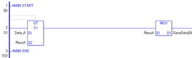
(1) Die Daten\_A und das Operationsergebnis werden verglichen, um festzustellen, ob die Daten\_A größer sind als das Operationsergebnis. Wenn das Ergebnis der GT Anweisung  $S1 > S2$  ist, lässt die GT-Anweisung Spannung durch. Die Anweisung rechts der GT-Anweisung wird daraufhin ausgeführt. In der obigen Abbildung handelt es sich dabei um eine MOV-Anweisung.
