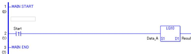
(1) Wenn die positive Übergangsanweisung eingeschaltet wird, wird die LG10-Anweisung ausgeführt. Die LG10-Anweisung berechnet die allgemeine Logarithmusfunktion Daten\_A und speichert das Ergebnis in D1.
