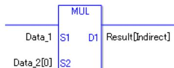
{Daten 1 = 1 Schritt} + {Daten 2 [0] = 2 Schritte} + {Ergebnis [Indirekt bestimmen] = 3 Schritte} + {1 Schritt} = 7 Schritte
