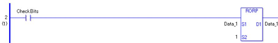
RORP- und ROR-Anweisungen erkennen auf unterschiedliche Weise, wann die Ausführung durchgeführt werden soll. Bei RORP-Anweisungen wird bei Verwenden einer normalerweise offenen Anweisung nur der Übergang nach oben festgestellt und die RORP-Anweisung wird ausgeführt. Deshalb wird die RORP-Anweisung nur für eine Abstimmung ausgeführt, selbst wenn die Bitbestätigung sich weiterhin einschaltet.
