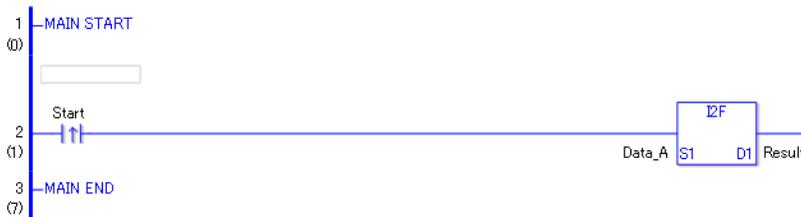
(1) Wenn die positive Übergangsanweisung eingeschaltet wird, wird die I2F-Anweisung ausgeführt. Wenn die I2F-Anweisung ausgeführt wird, wird das Ergebnis der I2F-Konvertierung der Daten\_A in D1 gespeichert.
