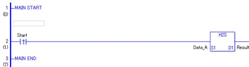
(1) Wenn die positive Übergangsanweisung eingeschaltet wird, wird die H2S-Anweisung ausgeführt. Wenn die H2S-Anweisung ausgeführt wird, wird das Ergebnis der H2S-Konvertierung der Daten\_A in D1 gespeichert.
