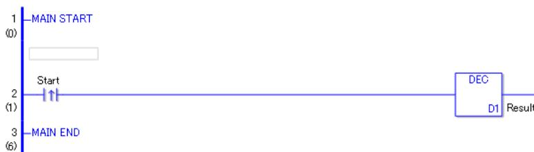
(1) Wenn die positive Übergangsanweisung eingeschaltet wird, wird die DEC-Anweisung ausgeführt. Wenn die DEC-Anweisung ausgeführt wird, wird 1 von D1 (Ganzzahlvariable) abgezogen. Wenn eine normalerweise offene Anweisung verwendet wird, wird die DEC-Anweisung fortlaufend ausgeführt und zieht 1 von D1 solange die Anweisung Spannung durchlässt.
