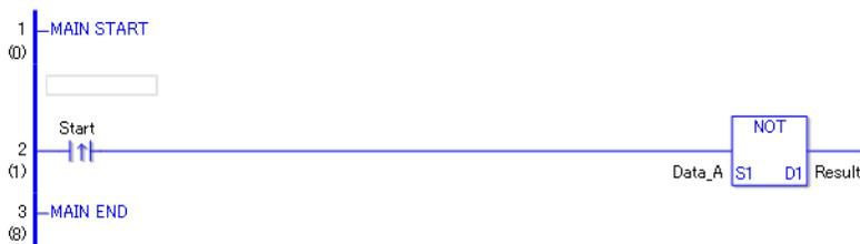
(1) Wenn die positive Übergangsanweisung eingeschaltet wird, wird die NOT-Anweisung ausgeführt. Wenn die NOT-Anweisung ausgeführt wird, wird der Ergebniswert in D1 gespeichert, nachdem die Daten\_A logisch invertiert wurden.
