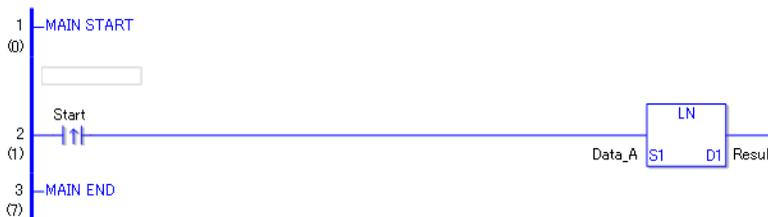
(1) Wenn die positive Übergangsanweisung eingeschaltet wird, wird die LN-Anweisung ausgeführt. Die LN-Anweisung berechnet die natürliche logarithmische Funktion der Daten A und speichert das Ergebnis in D1.
