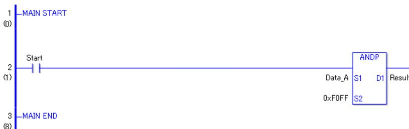
(1) Wenn sich die normalerweise offene Anweisung einschaltet, wird die ANDP-Anweisung ausgeführt. Wenn die ANDP-Anweisung ausgeführt wird, wird der Ergebniswert in D1 gespeichert, nachdem die Daten\_A mit F0FF durch AND logisch verknüpft wurden. Die ANDP-Anweisung wird nur ausgeführt, wenn ein Übergang nach oben festgestellt wird, selbst wenn eine normalerweise offene Anweisung verwendet wird.
