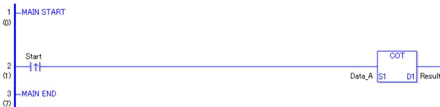
(1) Wenn sich die positive Übergangsanweisung einschaltet, wird die COT-Anweisung ausgeführt. Die COT-Anweisung berechnet den Kotangens der Daten\_A und speichert das Ergebnis in D1.
