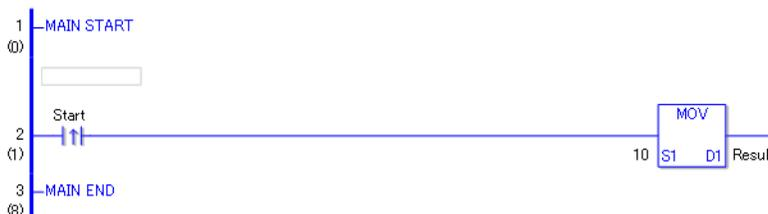
(1) Wenn die positive Übergangsanweisung eingeschaltet wird, wird die MOV-Anweisung ausgeführt. Wenn die MOV-Anweisung ausgeführt wird, wird die Konstante 10 in D1 gespeichert.
