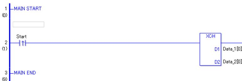
(1) Wenn die positive Übergangsanweisung eingeschaltet wird, wird die XCH-Anweisung ausgeführt. Wenn die XCH-Anweisung ausgeführt wird, wird die Zusammenfassung der Daten\_1[0] in D1 und der Daten\_2[0] in D2 ausgetauscht.
