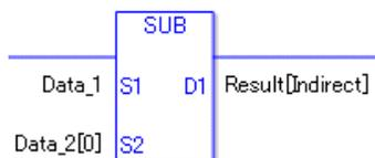
{Daten 1 = 1 Schritt} + {Daten 2 [0] = 2 Schritte} + {Ergebnis [Indirekt bestimmen] = 3 Schritte} + {1 Schritt} = 7 Schritte
