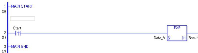
(1) Wenn die positive Übergangsanweisung eingeschaltet wird, wird eine EXP-Anweisung ausgeführt. Die EXP-Anweisung berechnet den Exponenten der Daten\_A und speichert das Ergebnis in D1.
