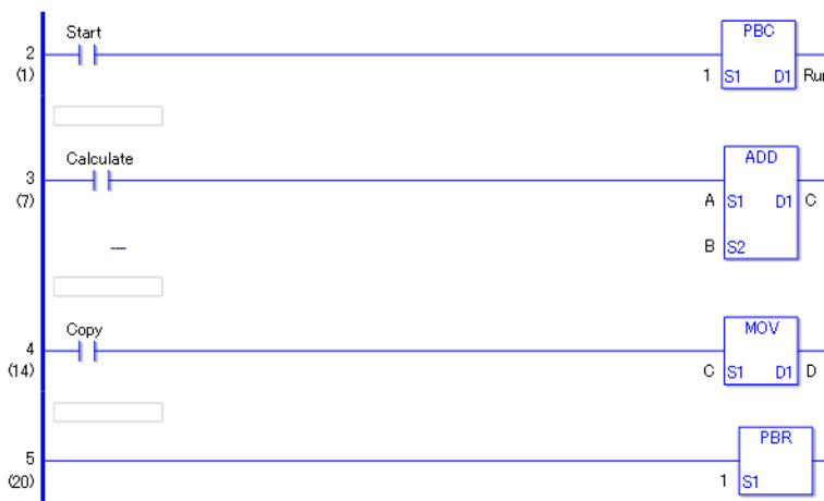
Wenn die Variable einer normalerweise offenen Anweisung eingeschaltet ist, wird die PBC-Anweisung ausgeführt. Wenn die PBC-Anweisung ausgeführt wird, wird die Verarbeitung zwischen PBC und PBR ausgeführt.
