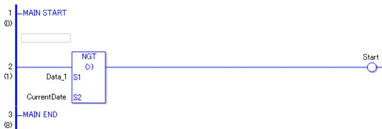
(1) Die Daten 1 und das aktuelle Datum werden verglichen, um festzustellen, ob die Daten 1 größer sind. Wenn das Ergebnis  $S1 > S2$  ist, lässt die Anweisung Spannung durch und die Anweisung rechts der NJGT-Anweisung wird ausgeführt. In der obigen Tabelle befindet sich die OUT-Anweisung rechts der NJGT-Anweisung und wird demnach ausgeführt.
