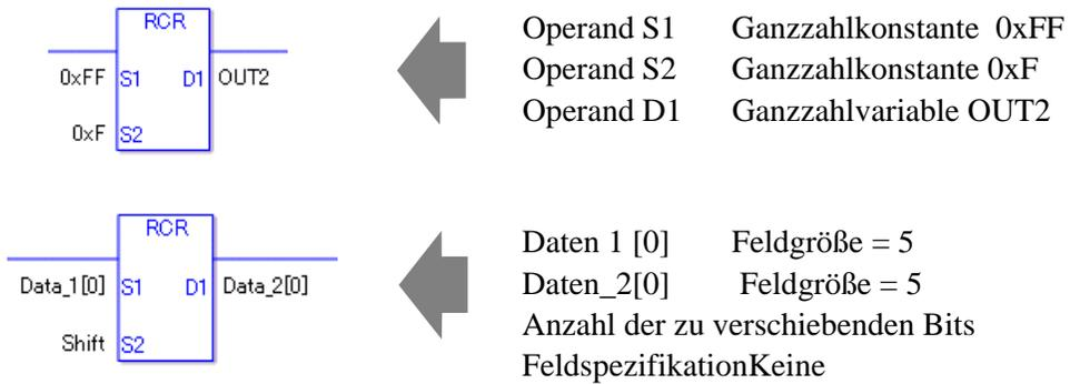
Wenn es sich sowohl bei S1 und D1 um kein Feld handelt, werden 32 Bits mit Lastenübertrag gedreht.
