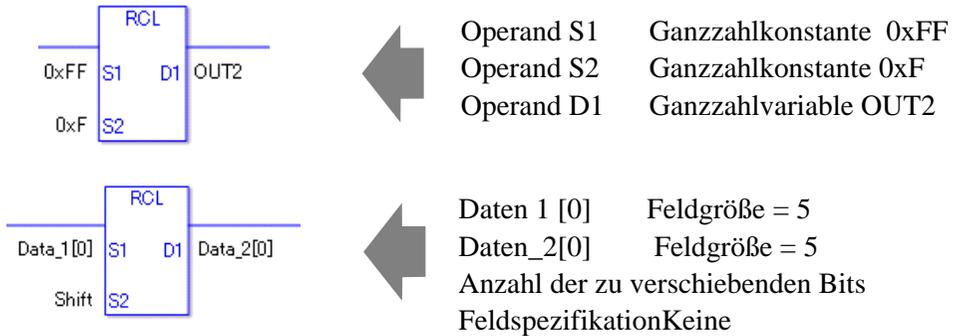
Wenn es sich sowohl bei S1 und D1 um kein Feld handelt, werden 32 Bits mit Lastenübertrag gedreht.
