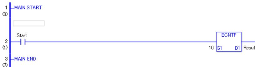
(1) BCNTP- und BCNT-Anweisungen unterscheiden sich darin, wann sie ausführen. Bei BCNTP-Anweisungen wird bei Verwenden einer normalerweise offenen Anweisung nur der Übergang nach oben festgestellt und die BCNT-Anweisung wird ausgeführt. Selbst wenn die Variable der NO-Anweisung immer EIN ist, wird die BCNTP-Anweisung nur einmal (bei der ersten Abtastung) ausgeführt.
