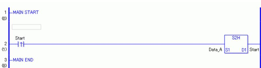
(1) Wenn die positive Übergangsanweisung eingeschaltet wird, wird die S2H-Anweisung ausgeführt. Wenn die S2H-Anweisung ausgeführt wird, wird das Ergebnis der S2H-Konvertierung der Daten\_A in D1 gespeichert.
