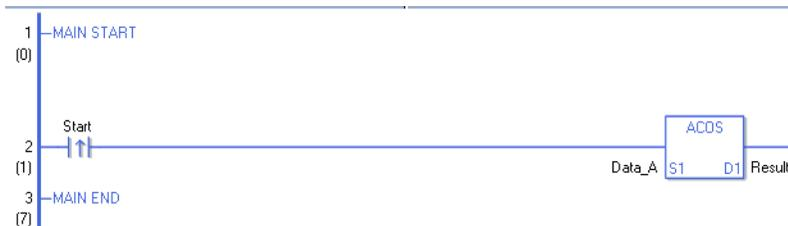
(1) Wenn sich die positive Übergangsanweisung einschaltet, wird die ACOS-Anweisung ausgeführt. Die ACOS-Anweisung berechnet den Arkuskosinus der Daten\_A und speichert das Ergebnis in D1.
