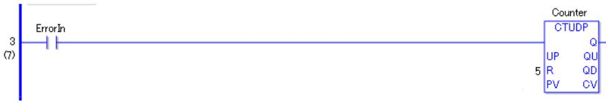
Der Unterschied zwischen einer CTUD- und einer CTUDP-Anweisung besteht darin, ob der .CV-Wert als Stufenzähler oder als positiver Übergangszähler erhöht oder verringert wird. Der Unterschied bei der Programmerstellung ist, dass der positive Übergang einer normalerweise offenen Anweisung in Reihe 3 zum Feststellen von Operationsfehlern eine normalerweise offene Anweisung ist. Es gibt keinen Unterschied bei der Operation, außer wie die Eingabe bestimmt wird.
