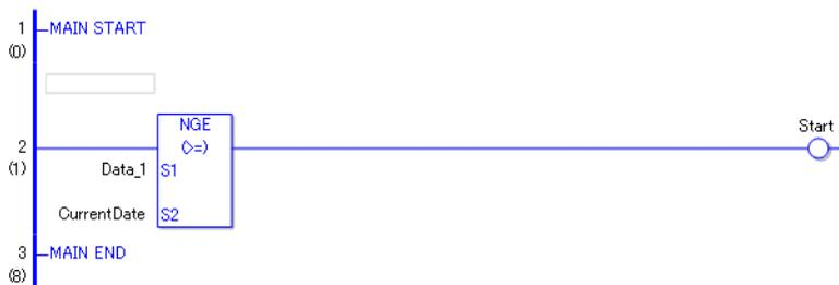
(1) Die Daten 1 und das aktuelle Datum werden verglichen, um festzustellen, ob die Daten 1 größer oder gleich sind. Wenn das Ergebnis  $S1 \geq S2$  ist, lässt die Anweisung Spannung durch und die Anweisung rechts der NGE-Anweisung wird ausgeführt. In der obigen Tabelle befindet sich die OUT-Anweisung rechts der NGE-Anweisung und wird demnach ausgeführt.
