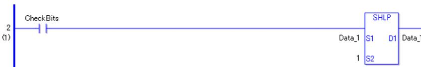
SHLP- und SHL-Anweisungen erkennen auf unterschiedliche Weise, wann die Ausführung durchgeführt werden soll. Bei SHLP-Anweisungen wird bei Verwenden einer normalerweise offenen Anweisung nur der Übergang nach oben festgestellt und die SHLP-Anweisung wird ausgeführt. Deshalb wird die SHLP-Anweisung nur für eine Abtastung ausgeführt, selbst wenn die normalerweise offene Anweisung eingeschaltet bleibt.
