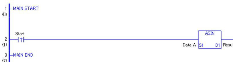
(1) Die ASIN-Anweisung wird ausgeführt, wenn sich die positive Übergangsanweisung einschaltet. Die ASIN-Anweisung berechnet den Arkussinus der Daten\_A und speichert das Ergebnis in D1.
