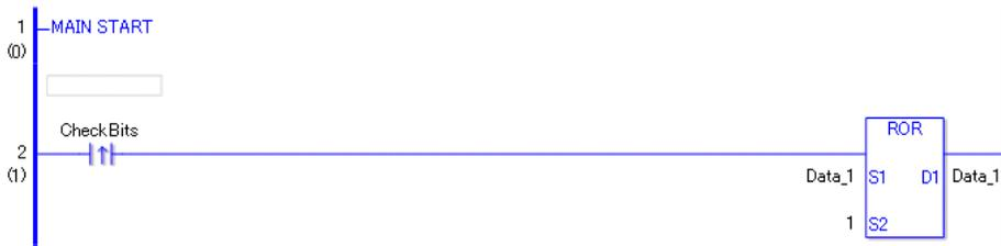
(1) Wenn eine positive Übergangsanweisung eingeschaltet wird, wird die ROR-Anweisung ausgeführt. Wenn eine ROR-Anweisung ausgeführt wird, wird das Ergebnis (1 Bit drehen) in D1 gespeichert.
