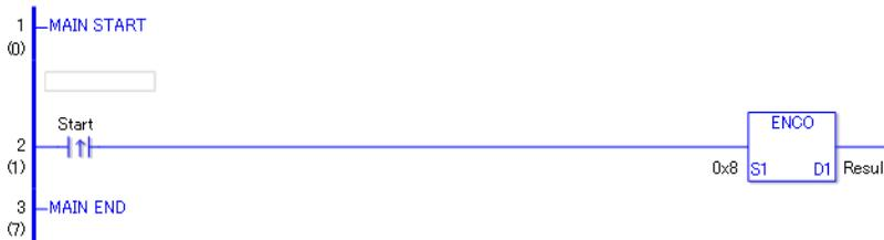
(1) Wenn die positive Übergangsanweisung eingeschaltet wird, wird die ENCO-Anweisung ausgeführt. Wenn die ENCO-Anweisung ausgeführt wird, wird 0000 1000 (8 in hexadezimal) konvertiert und der Binärwert 0011 (3) in D1 gespeichert. Wenn eine normalerweise offene Anweisung besteht, wird die ENCO-Anweisung immer ausgeführt, solange die Anweisungsvariable EIN ist.
