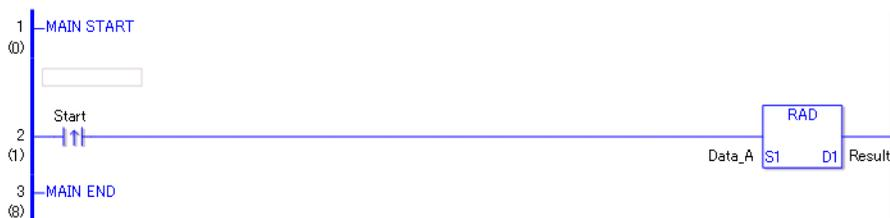
(1) Wenn die positive Übergangsanweisung eingeschaltet wird, wird die RAD-Anweisung ausgeführt. Wenn die RAD-Anweisung ausgeführt wird, wird das Ergebnis der Daten\_A in D1 gespeichert.
