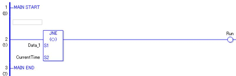
(1) Die Daten 1 und die aktuelle Zeit werden verglichen, um festzustellen, ob sie ungleich sind. Wenn das Ergebnis  $S1 \neq S2$  ist, lässt die Anweisung Spannung durch und die Anweisung rechts der JNE-Anweisung wird ausgeführt. In der obigen Tabelle befindet sich die OUT-Anweisung rechts der JNE-Anweisung und wird demnach ausgeführt.
