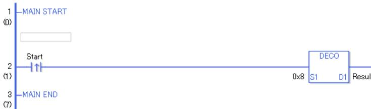
(1) Wenn die positive Übergangsanweisung eingeschaltet wird, wird die DECO-Anweisung ausgeführt. Wenn die DECO-Anweisung ausgeführt wird, wird 0000 1000 (8 in hexadezimal) konvertiert und der Binärwert 1 0000 0000 in D1 gespeichert.
