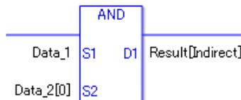
{Daten 1 = 1 Schritt} + {Daten 2 [0] = 2 Schritte} + {Ergebnis [Indirekt bestimmen] = 3 Schritte} + {1 Schritt} = 7 Schritte
