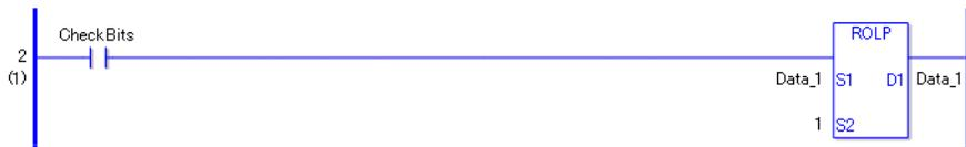
ROLP- und ROL-Anweisungen erkennen auf unterschiedliche Weise, wann die Ausführung durchgeführt werden soll. Bei ROLP-Anweisungen wird selbst bei einer normalerweise offenen Anweisung nur der Übergang nach oben festgestellt und die ROLP-Anweisung wird ausgeführt. Deshalb wird die ROLP-Anweisung nur für eine Abtastung ausgeführt, selbst wenn das Bit eingeschaltet bleibt.
