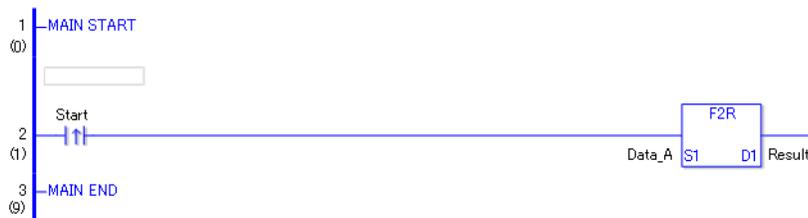
(1) Wenn die positive Übergangsanweisung eingeschaltet wird, wird die F2R-Anweisung ausgeführt. Wenn die F2R-Anweisung ausgeführt wird, wird das Ergebnis der F2R-Konvertierung der Daten\_A in D1 gespeichert.
