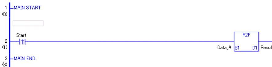
(1) Wenn die positive Übergangsanweisung eingeschaltet wird, wird die R2F-Anweisung ausgeführt. Wenn die R2F-Anweisung ausgeführt wird, wird das Ergebnis der R2F-Konvertierung der Daten\_A in D1 gespeichert.
