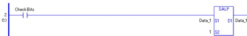
SALP- und SAL-Anweisungen erkennen auf unterschiedliche Weise, wann die Ausführung durchgeführt werden soll. Bei SALP-Anweisungen wird bei Verwenden einer normalerweise offenen Anweisung die SALP-Anweisung nur ausgeführt, wenn ein positiver Übergang festgestellt wird. Deshalb wird die SHLP-Anweisung nur für eine Abtastung ausgeführt, selbst wenn die normalerweise offene Anweisung eingeschaltet bleibt.
