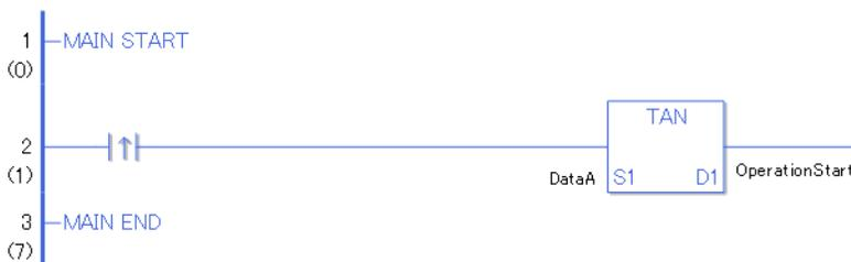
(1) Wenn die positive Übergangsanweisung eingeschaltet wird, wird eine TAN-Anweisung ausgeführt. Die TAN-Anweisung berechnet den Tangens der Daten\_A und speichert das Ergebnis in D1.
