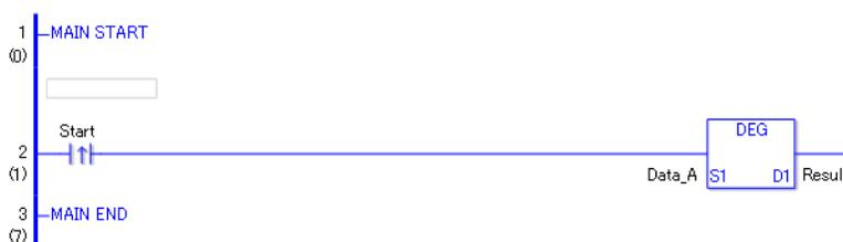
(1) Wenn die positive Übergangsanweisung eingeschaltet wird, wird die DEG-Anweisung ausgeführt. Wenn die DEG-Anweisung ausgeführt wird, wird das Ergebnis der Daten\_A in D1 gespeichert.
