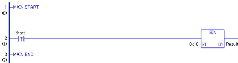
(1) Wenn die positive Übergangsanweisung eingeschaltet wird, wird die BIN-Anweisung ausgeführt. Wenn die BIN-Anweisung ausgeführt wird, wird 0001 0000 (10 in hexadezimal) in eine Binärzahl konvertiert und der Wert 1010 in D1 gespeichert. Wenn eine normalerweise offene Anweisung besteht, wird die BIN-Anweisung immer ausgeführt, solange die Anweisungsvariable EIN ist.
