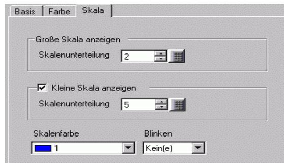
**ANMERKUNG** • Bei Grafikelementen mit einer Skala können Skala-Beschriftungen automatisch mit Hilfe eines Text-Elements abgelegt werden. Klicken Sie mit der rechten Maustaste auf das Grafik-Element mit einer Skala und klicken auf [Skala-Beschriftungsablage] aus dem angezeigten Menü. Das Dialogfeld [Text] wird angezeigt. Richten Sie jedes Element ein und klicken auf [OK].
