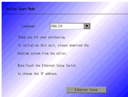
หน้าจอนี้จะปรากฏขึ้นเมื่อคุณเสียบปลั๊กไฟของเครื่อง GP เป็นครั้งแรก หลังจากถ่ายโอนโปรเจค หน้าจอนี้จะไม่ปรากฏขึ้น
