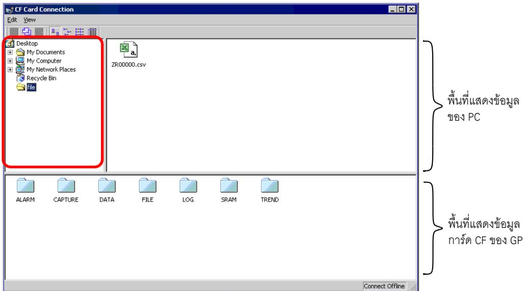
4 เลือกข้อมูลสูตรทำงาน (ZR00000.csv) จากข้อมูลที่แสดงในด้านขวา แล้วลากไปที่พื้นที่การ์ด CF ที่ด้านล่าง
