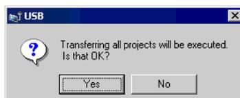
กล่องโต้ตอบต่อไปนี้จะปรากฏขึ้นระหว่างถ่ายโอนไฟล์ คุณจึงสามารถตรวจสอบสถานะการสื่อสารได้ (GP จะเปลี่ยนเป็นโหมดการถ่ายโอน และตัดการสื่อสารกับอุปกรณ์ (PLC))
