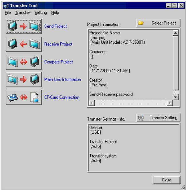
5 คลิกที่ปุ่ม [Transfer Settings] กล้องโต้ตอบต่อไปนี้จะเปิดขึ้น เลือก [LAN] ที่ [Communication Port Settings] ตรวจสอบว่าได้ทำเครื่องหมายที่ช่อง [LAN Auto Setting] แล้ว จากนั้นคลิก [OK]
