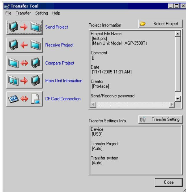
2 คลิกปุ่ม [Transfer Setting] กล่องโต้ตอบ [Transfer Settings] ต่อไปนี้จะปรากฏขึ้น เลือก [LAN] ที่ [Communication Port Settings] ทำเครื่องหมายที่ช่อง [LAN Auto Setting] แล้วคลิก [OK]
