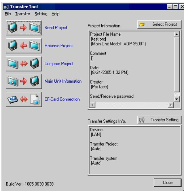
3 คลิก [Receive Project] กล่องโต้ตอบ [Save As] จะปรากฏขึ้น ระบุตำแหน่ง [Save in] และ [File name] ของข้อมูลที่จะรับ แล้วคลิก [Save]
