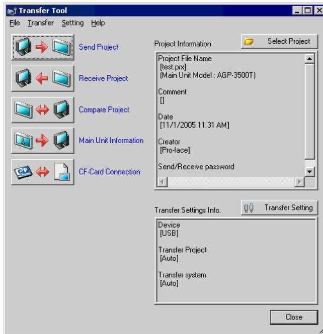
2 คลิก [CF-Card Connection] กล้องโต้ตอบต่อไปนี้จะปรากฏขึ้น เลือก [Connect Offline] แล้วคลิก [OK]
