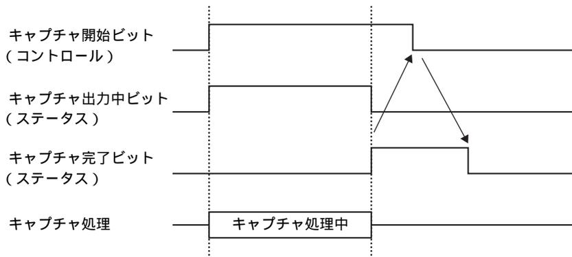
キャプチャ完了ビットが ON する前に開始ビットが OFF した場合でも、キャプチャ完了ビットは自動的に OFF します。
