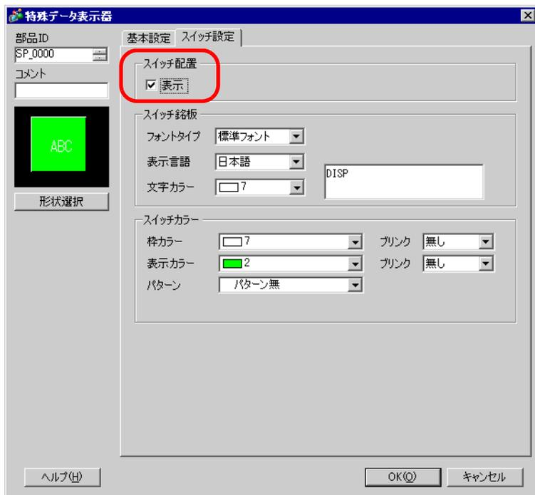
特殊データ表示器 [ファイルマネージャ] が設定できました。[ファイルマネージャ] の [スイッチ設定] タブで配置したスイッチは、個別に選択して任意の位置に移動できます。
