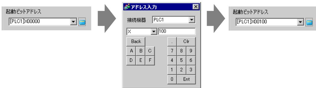
6 監視条件として[コントロールワードアドレス]を選択し、監視をコントロールするアドレス（例：D100）を設定します。指定したアドレスから連続2ワードを使用してコントロールします。
