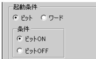
5 [起動ビットアドレス]に保存開始のビットアドレス（例：X100）を設定します。
