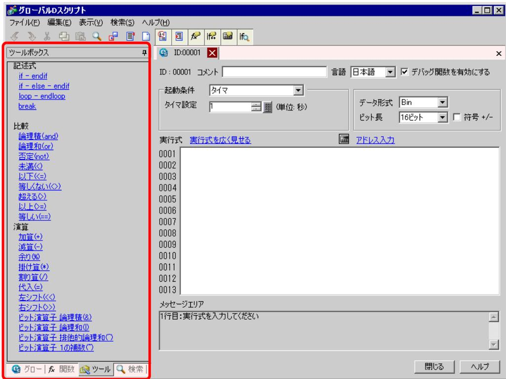
6 1行目のスクリプトを作成します。1行目の動作は、D00100の初期値を0とすると、処理毎に1ずつ増加して格納されるカウント動作です。
