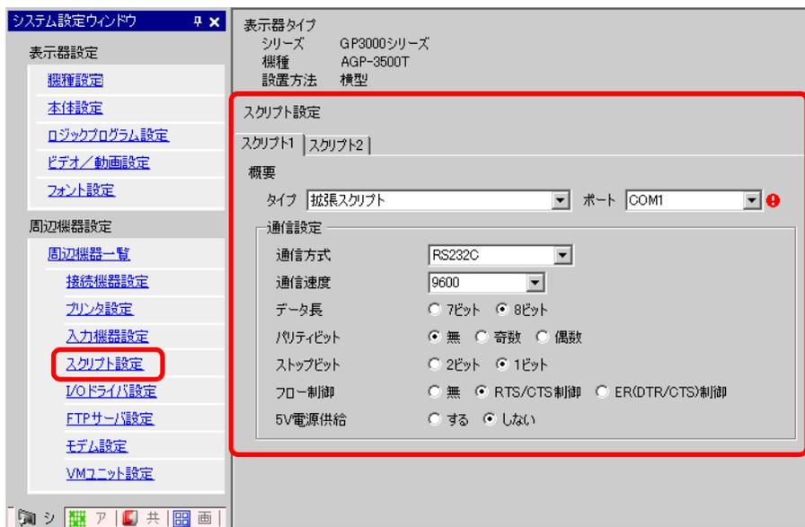
[スクリプト設定] には2つタブがあります。上記の例では [スクリプト 1] タブを使用しています。[ポート] は COM1 または COM2 を、[通信設定] の詳細は通信相手の外部機器に合わせて指定してください。
