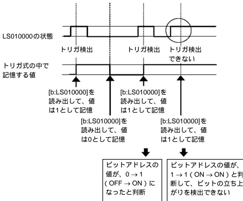
例のようなD スクリプトをタッチのタイミングに依存せずに検出する方法として、次のように記述してください。
