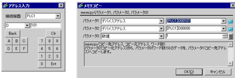
9 アドレス数に 100 を入力し、手順 8 と同様にコピー元ワードアドレスに D00000 を指定して [OK] をクリックします。
