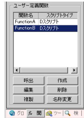
関数名を入力し、登録するスクリプトを実行フィールドに作成します。[OK] をクリックするとユーザー定義関数として登録されます。
