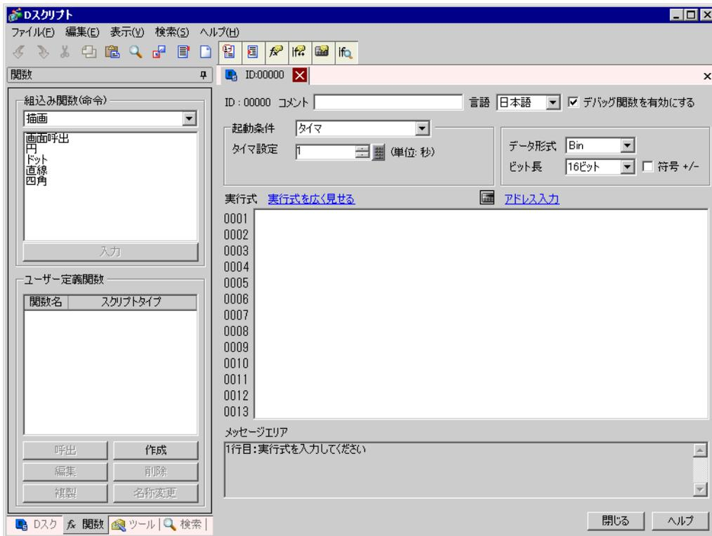
4 スクリプトの起動条件（トリガ）で「ビット ON」を選択し、「ビットアドレス」は M000100 を指定します。
