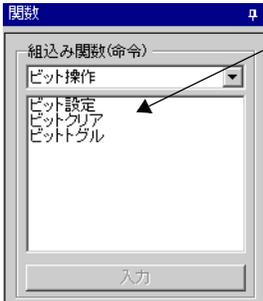
上部のプルダウンメニューから分類を選択すると、下部に関連する関数が表示されます。<br>関数を選択した状態で[入力]をクリックすると、各種設定ダイアログボックスが表示されます |
