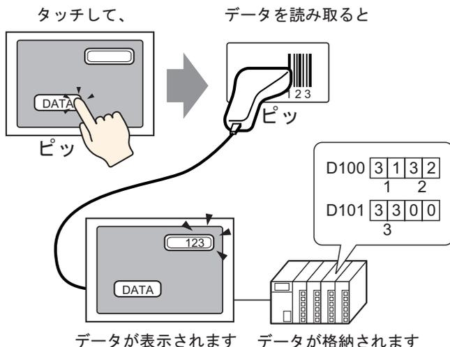
同じように、2次元コードリーダーから読み取ったコードデータをデータ表示部品を通じて接続機器のデバイスアドレスに格納したり、GPの内部デバイスアドレスに格納することができます。
