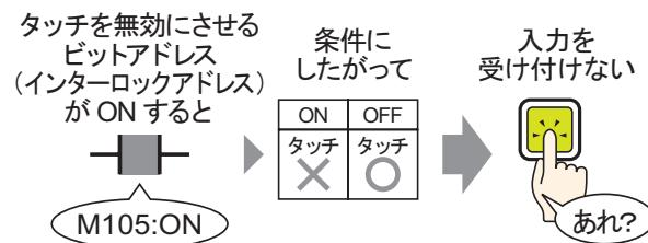
インターロックアドレスで設定されたビットアドレスが、タッチ有効条件と成立した場合のみタッチ操作を有効にします。
