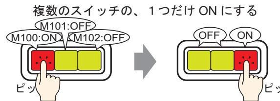
複数のスイッチを同じグループで登録しておくと、グループ内のひとつのスイッチをタッチして指定ビットをONすれば、残りのスイッチはすべてOFFになります。
