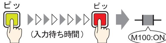
スイッチを1回押すと点滅がはじまります。入力待ち状態の開始です。点滅中（入力待ち状態）に再度スイッチを押すと指定したビットがONになります。誤った入力を防ぐのに適しています。
