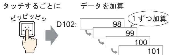
1 [ 部品 (P) ] メニューの [ スイッチランプ (C) ] から [ ワードスイッチ (W) ] を選択するか、
