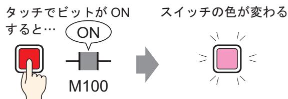
スイッチにランプ機能を組み合わせると、指定したアドレスの状態（ON/OFFなど）に応じてスイッチの色を切り替えられます。
