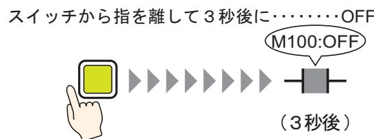
スイッチを押して指を離した後、一定の時間（例 3 秒）が経過してから指定ビットを OFF します。
