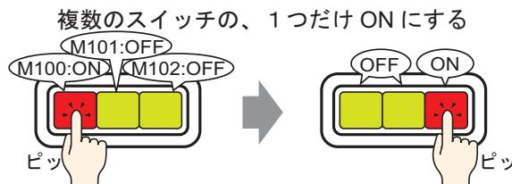
1 [部品(P)] メニューの [スイッチランプ] から [ビットスイッチ] を選択するか、
