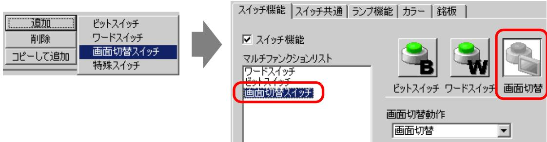
11 [画面切替動作]で[前画面に戻る]を選択します。画面切替スイッチの機能は設定完了です。
