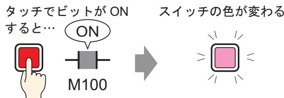
1 [ 部品 (P) ] メニューの [ スイッチランプ (C) ] から [ ビットスイッチ (B) ] を選択するか、
