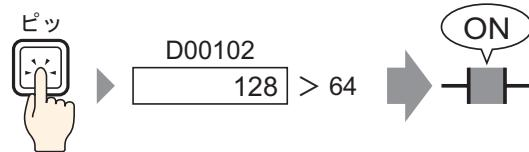
スイッチを押すと、あるワードアドレスのデータ（例 128）と設定した「定数」（例 64）を比較します。条件（例「ワードアドレスデータは定数より大きい」）が成立した場合、指定したビットが ON になります。
