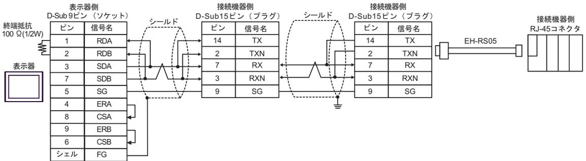
C. (株) デジタル製オンラインアダプタ (CA4-ADPONL-01)、(株) デジタル製コネクタ端子台変換アダプタ (CA3-ADPTRM-01)、自作ケーブルおよび (株) 日立産機システム製変換ケーブル (EH-RS05) を使用する場合
