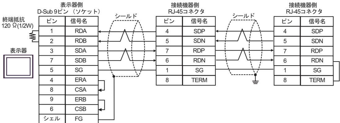
C. (株) デジタル製オンラインアダプタ (CA4-ADPONL-01)、(株) デジタル製コネクタ端子台変換アダプタ (CA3-ADPTRM-01) および自作ケーブルを使用する場合
