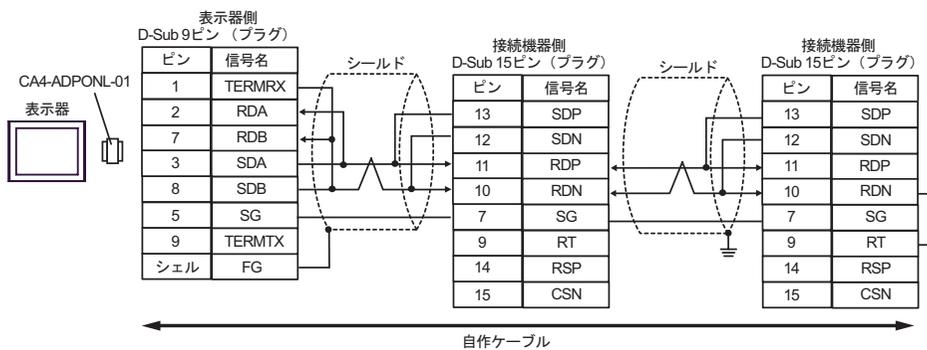
E. (株) デジタル製 COM ポート変換アダプタ (CA3-ADPCOM-01)、(株) デジタル製コネクタ端子台変換アダプタ (CA3-ADPTRM-01) および自作ケーブルを使用する場合
