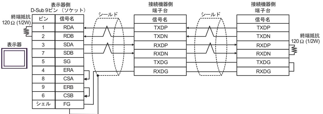
C. (株) デジタル製オンラインアダプタ (CA4-ADPONL-01)、(株) デジタル製コネクタ端子台変換アダプタ (CA3-ADPTRM-01) および自作ケーブルを使用する場合
