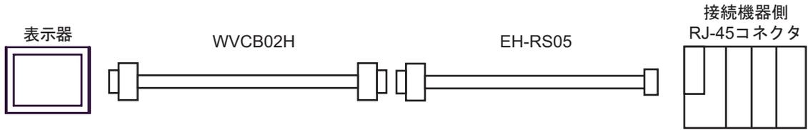
C. 自作ケーブル1 および (株) 日立産機システム製変換ケーブル (EH-RS05) を使用する場合
