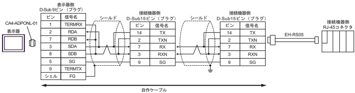
E. (株) デジタル製 COM ポート変換アダプタ (CA3-ADPCOM-01)、(株) デジタル製コネクタ端子台変換アダプタ (CA3-ADPTRM-01)、自作ケーブルおよび (株) 日立産機システム製変換ケーブル (EH-RS05) を使用する場合
