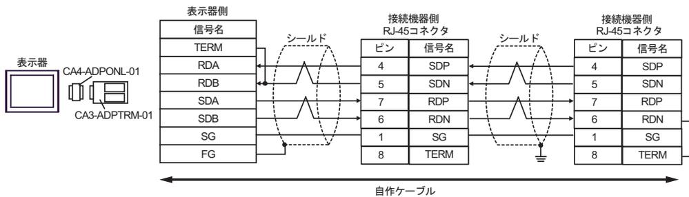
D. (株) デジタル製オンラインアダプタ (CA4-ADPONL-01) および自作ケーブルを使用する場合
