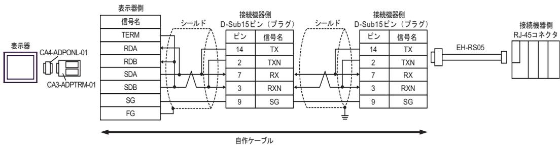
D. (株) デジタル製オンラインアダプタ (CA4-ADPONL-01)、自作ケーブルおよび (株) 日立産機システム製変換ケーブル (EH-RS05) を使用する場合
