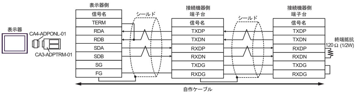
D. (株) デジタル製オンラインアダプタ (CA4-ADPONL-01) および自作ケーブルを使用する場合
