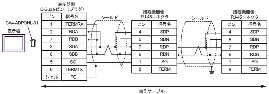
E. (株) デジタル製 COM ポート変換アダプタ (CA3-ADPCOM-01)、(株) デジタル製コネクタ端子台変換アダプタ (CA3-ADPTRM-01) および自作ケーブルを使用する場合
