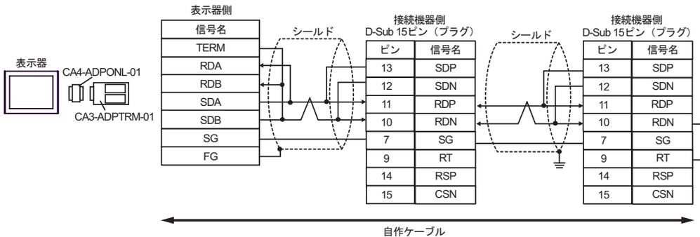
D. (株) デジタル製オンラインアダプタ (CA4-ADPONL-01) および自作ケーブルを使用する場合
