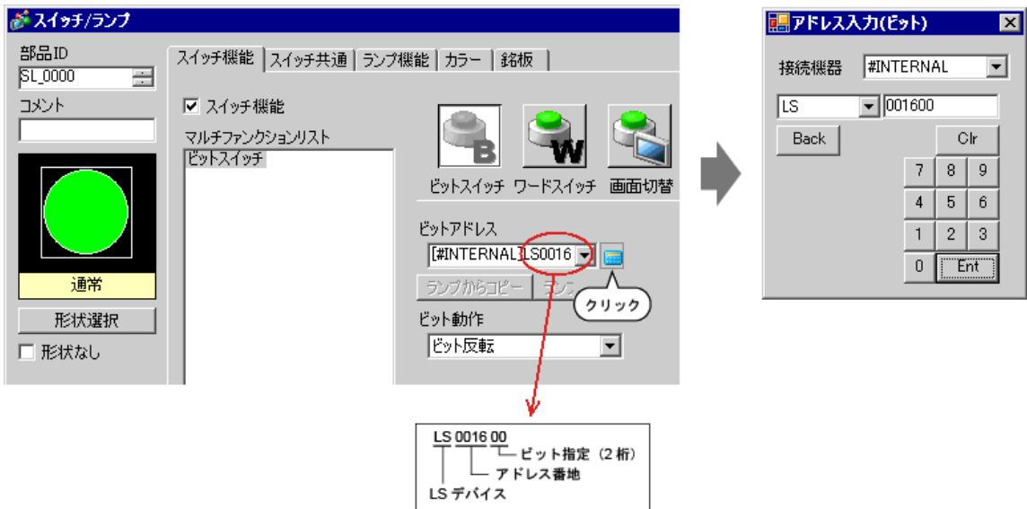
6 [ ビット動作 ] で [ ビット反転 ] を選択して、[OK] をクリックします。
