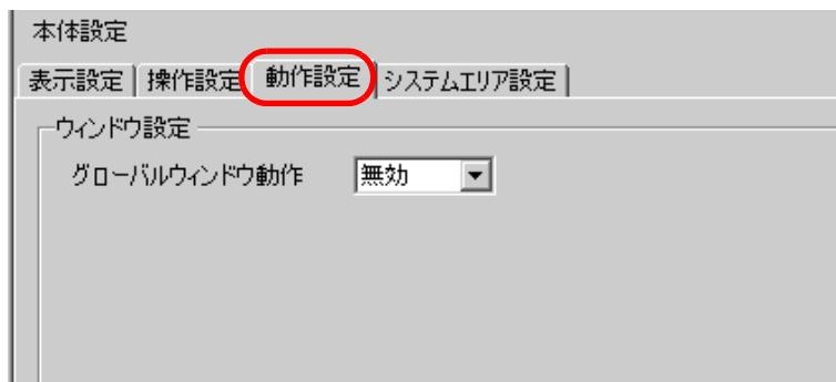
2 ウィンドウ設定の [ グローバルウィンドウ動作 ] で [ 直接 ] を選択します。
