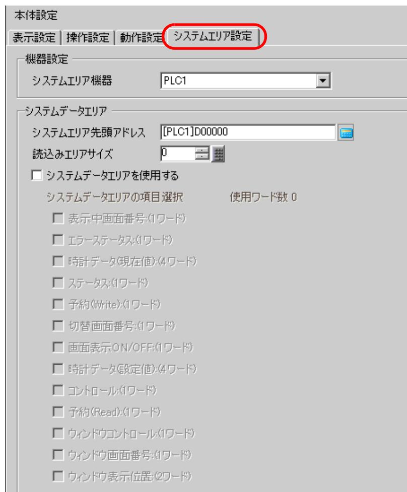
5 [システムエリア機器] でシステムエリアを使用する接続機器を指定し、[システムエリア先頭アドレス] に割り付ける先頭アドレス (D100) を指定します。
