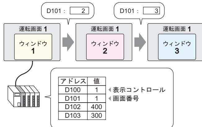
1 [部品(P)] メニューの [ ウィンドウ ] を選択するか、 をクリックし、ウィンドウ部品を画面に配置します。
