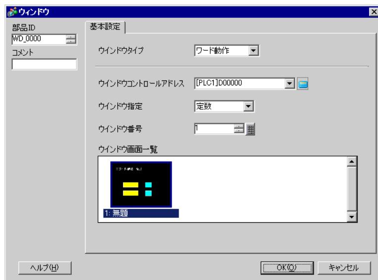
3 [ ウィンドウコントロールアドレス ] にウィンドウの表示をコントロールするワードアドレス ( D100 ) を設定します。
