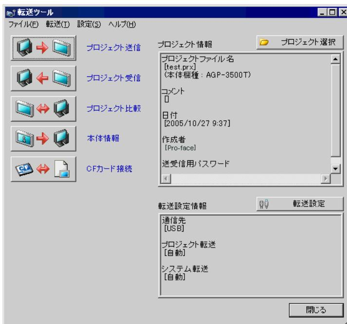
2 [CF カード接続] をクリックします。次のダイアログボックスが表示されますので、[オフライン接続] を選択して [OK] をクリックします。
