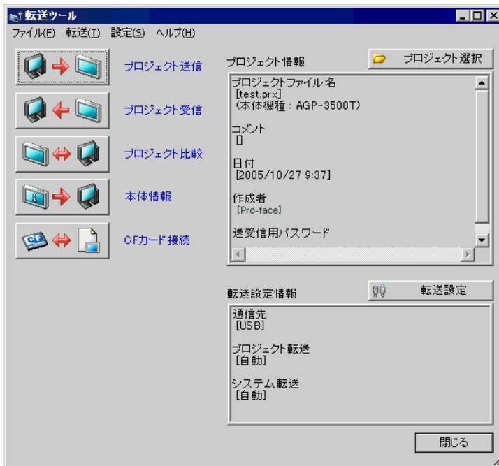
5 [転送設定] ボタンをクリックします。次のダイアログボックスが開きます。[通信ポートの設定] で [LAN] を選択し、[自動検索] にチェックが入っていることを確認して [OK] をクリックします。
