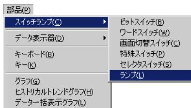
配置したランプをダブルクリックすると、設定ダイアログボックスが開きます。
