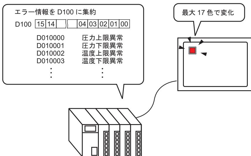
1 [部品(P)] メニューの [スイッチランプ(C)] から [ランプ(L)] を選択するか、 をクリックし、画面に配置します。
