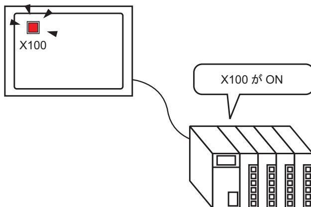
1 [部品(P)] メニューの [スイッチランプ(C)] から [ランプ(L)] を選択するか、 をクリックし、画面に配置します。
