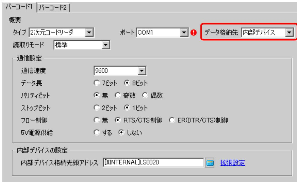
7 [内部デバイス格納先頭アドレス]でデータを格納する内部デバイスの先頭アドレスを(例:LS20)設定します。
