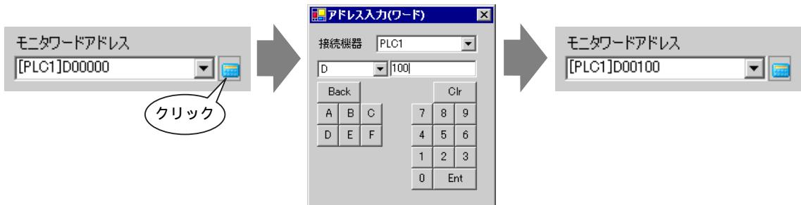
12 [モニタワードアドレス] から表示文字数分使用するワードアドレスの最後尾のアドレスが表示されます。
