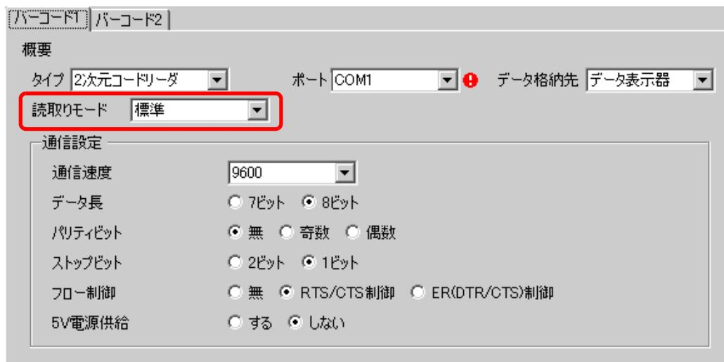
5 [ 通信設定 ] で [ 通信速度 ]、[ データ長 ]、[ パリティビット ]、[ ストップビット ]、[ フロー制御 ]、[ 5V 電源供給 ] を設定します。
