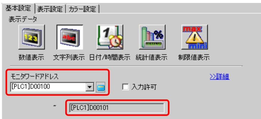
**MEMO** • 半角英数字であれば2文字で1ワード、全角文字であれば1文字で1ワード使用します。上記の場合、手順10で[表示文字数]を半角3文字と設定したので2ワード使用することになります。
