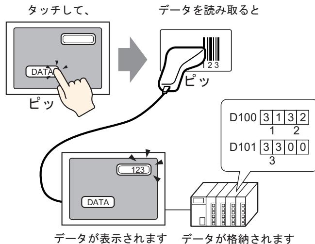
同じように、2次元コードリーダから読み取ったコードデータをデータ表示部品を通じて接続機器のデバイスアドレスに格納したり、GP の内部デバイスアドレスに格納することができます。
