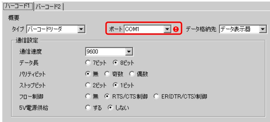
**MEMO** • ポートが他の接続機器と重複して使用されている場合は、上記のように[ポート]の右横に、が表示されます。
