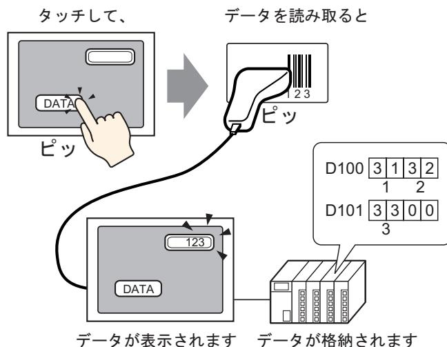
1 バーコードと通信する設定を行います。「プロジェクト(F)」メニューから [システム設定(C)] を選択するか、
