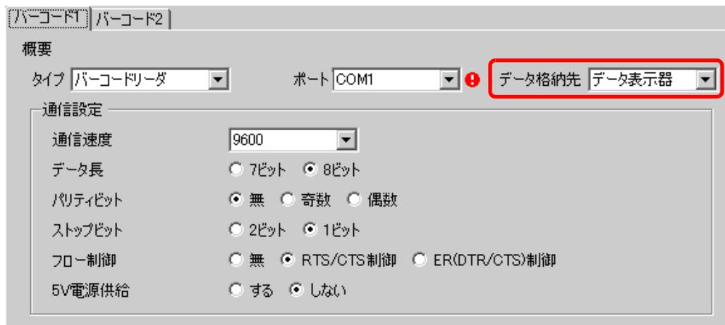
6 続いて、バーコードから読み取ったデータを表示するためのデータ表示部品を設定します。
