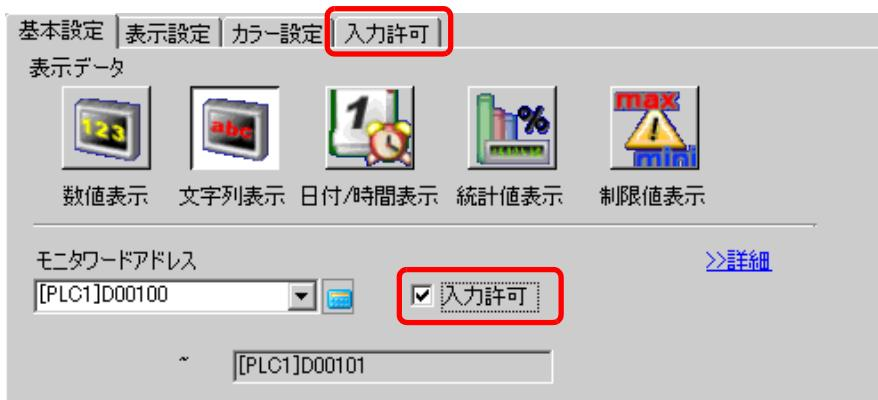
14 [入力許可] タブをクリックし、入力方法の種類で [ビット] を選択し、[詳細] をクリックします。
