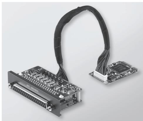
下图显示了 16DI/16DO DIN 导轨终端卡和电缆：
